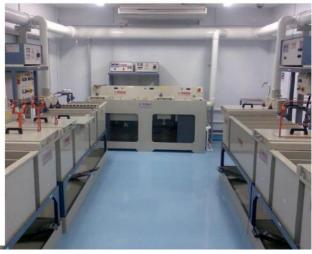
CHEMICAL BRIGHTENING UNIT ("BOMBING") TYPE FIOA. - 2 HEATED TANKS FOR CIANYDE SOLUTION.
